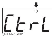
Luego aparecerá el mensaje [Ctrl][Off.] y la exhibición de la temperatura alternará con el mensaje [Off.]. Para reconectar las funciones de control, aplique el mismo procedimiento de desconexión seleccionando con la tecla ; (toque corto),
