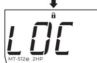
Para desbloquear, desconecte el controlador y vuelva a conectarlo con la tecla > presionada.
